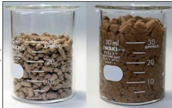
写真-1 (左) 浸水前 (右) 浸水 5 分後
